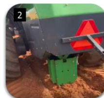
2 Movimentação do cabeçote plantador para o solo e transplanto da muda e início de irrigação
